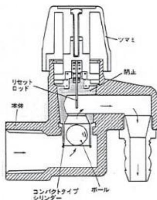
お客様が用意したプロパンガスボンベには通常上記の様なガスコックが付いていますが、このガスコックの中には図の様な安全装置が付いています。
